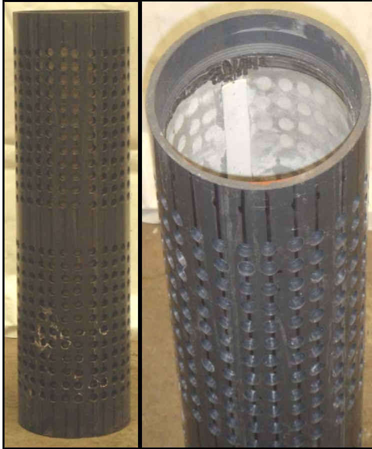
Figura 37. Elemento filtrante modificado.
