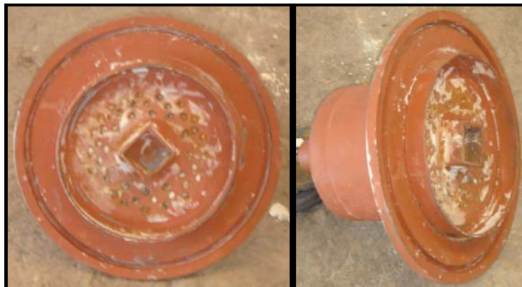
Figura 39. Tapa con separador de arena.
