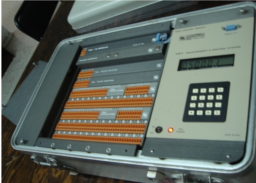
Figura A5. Datalogger (modelo CR7 Campbell Sci., Inc., Logan, Utah, USA)
