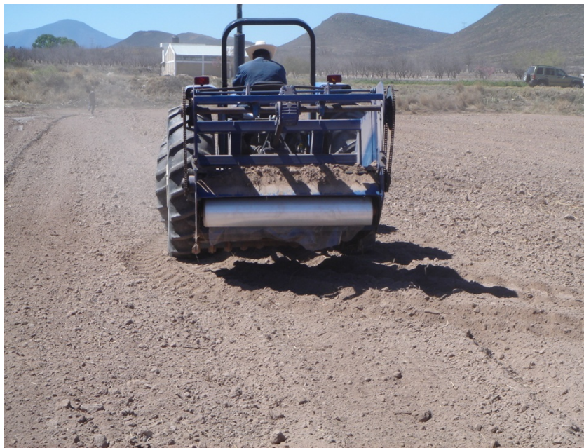
Figura A1. Implemento que coloca el plástico subsuperficial a 40 cm.
