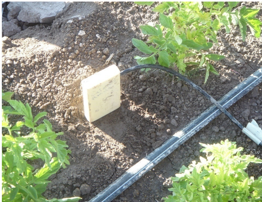
Figura A8. TDR establecido en campo correctamente.
