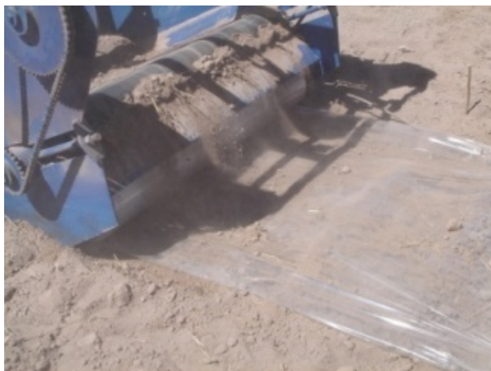
Figura 1. Implemento agrícola para enterrar el plástico subsuperficial a una profundidad de 40 cm bajo la superficie a lo largo de la cama de siembra.
