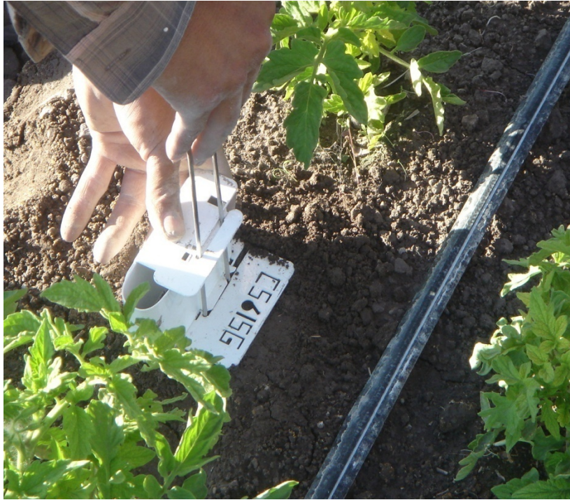
Figura A7. Base para la colocación correcta del TDR.
