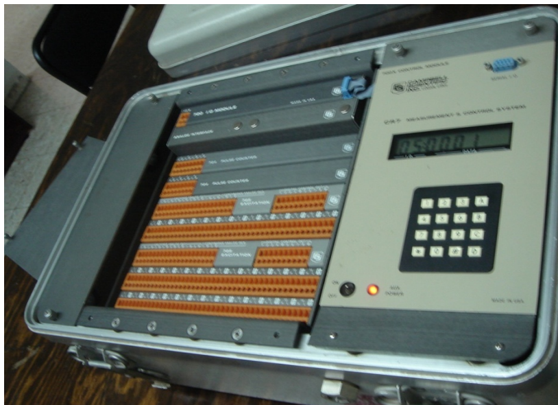
Figura 3. Registrador electrónico de datos "Datalogger" (modelo CR7 Campbell Sci., Inc., Logan, Utah, USA), donde se conectaron los TDR para el registro continuo de lecturas
