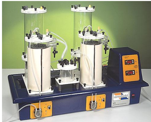
Figura 2.5. Biodigestor anaerobio ARMFIRLELD W8.
