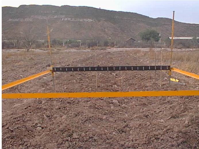
Fig. 3.4 Medición del microrrelieve.
