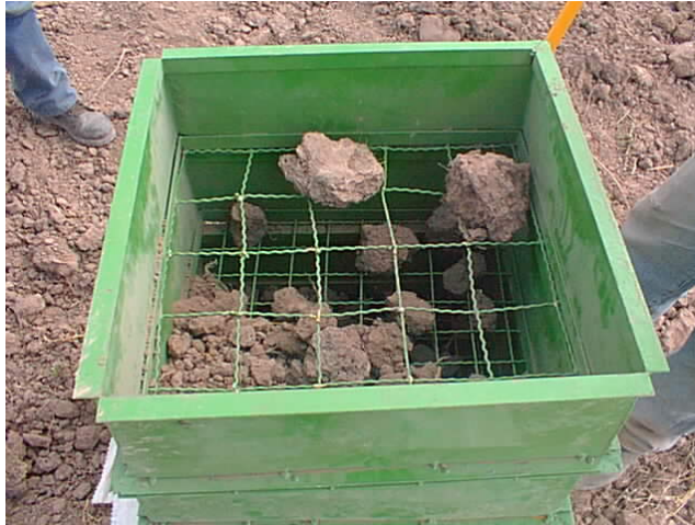
Fig. 3.11 Medición de tamaño de agregados.
