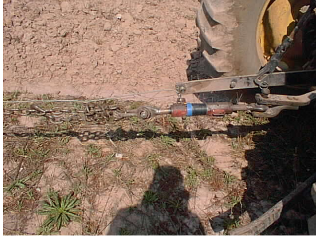
Fig. 3.7 Dinamómetro entre tractores.
