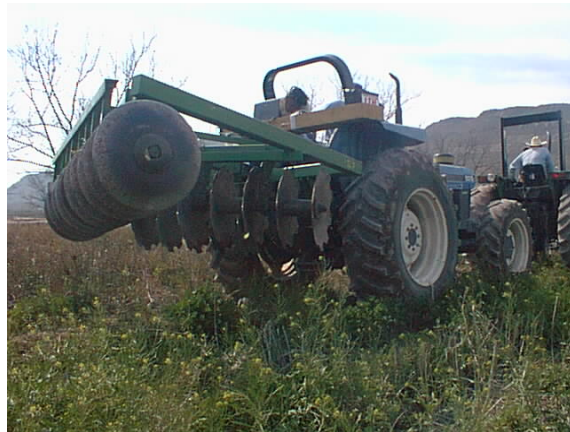
Fig. 3.8 Implemento arriba para la determinación de calibración de rodamiento.
