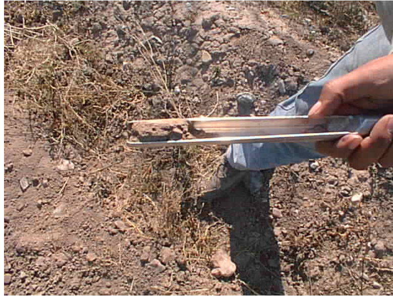
Fig. 3.2 Medición de humedad.
