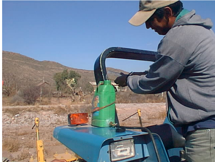
Fig. 3.6 Medición del gasto de combustible.
