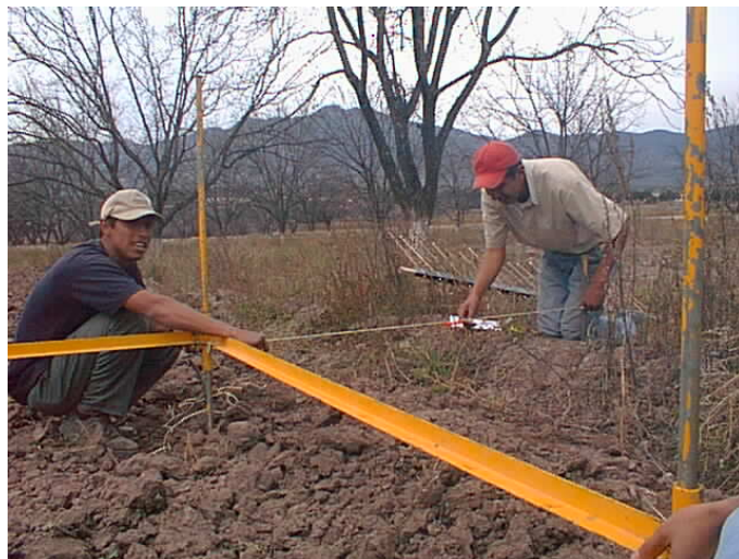
Fig. 3.12 Medición de microrrelieve después del paso de rastra.
