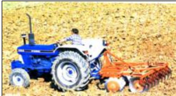
Fig. 2.3. Rastra montada en el enganche en tres puntos del tractor http://www.unisucre.edu.co/MaquinariaIngAgr/E_lab%20sec/2.clasif_Rast_disc.htm .
