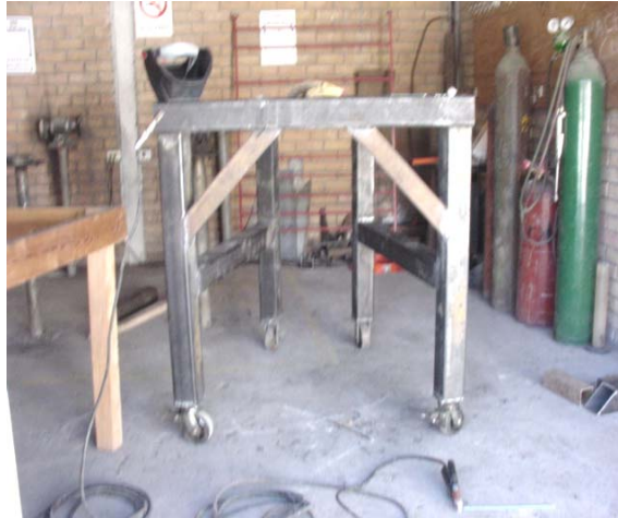
Figura 3.17 Estructura completamente soldada.
