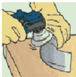
Figura 3.3 Limpieza de las piezas antes de soldar.
