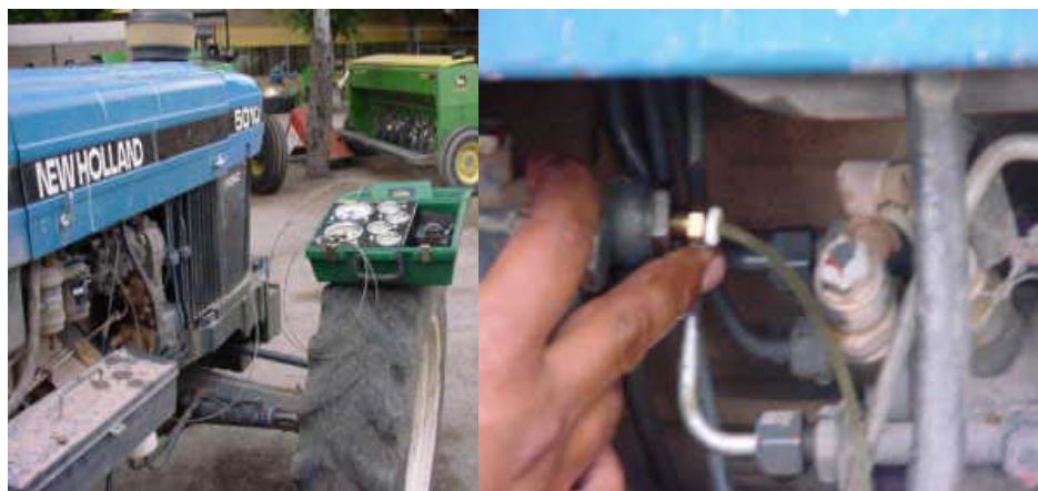
Figura 3.2 Medición de la presión en la línea de combustible.
