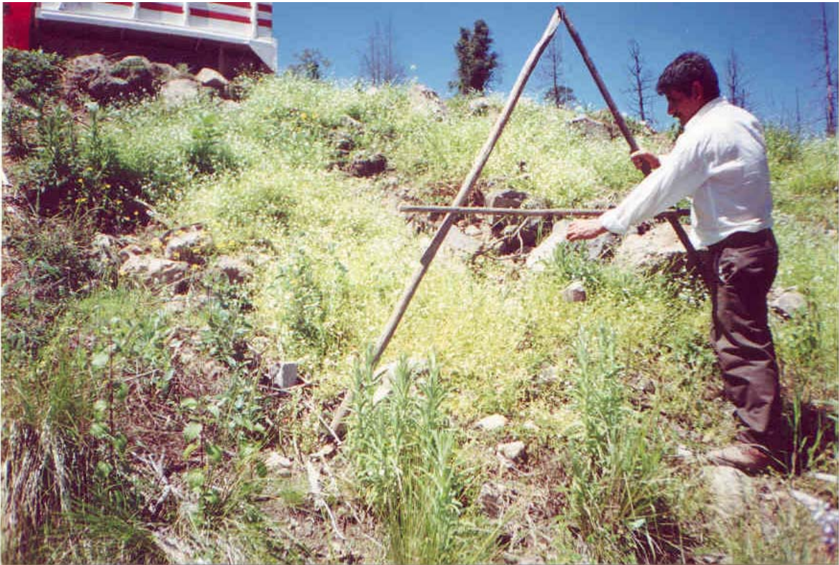
Figura 12. Trazo de curvas a nivel con el aparato "A"
