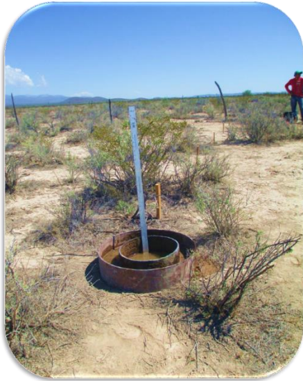
Equipo de infiltración
