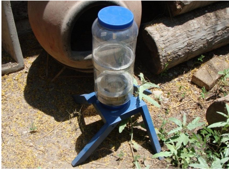
Figura 4. Cuerpo de la trampa WOT anclado a la base
