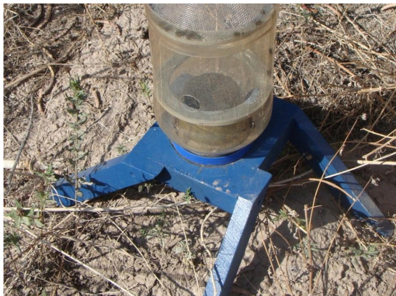
Figura 5. Recipiente inferior del cuerpo de la trampa
