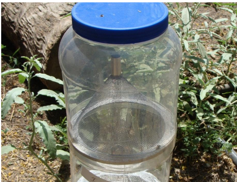
Figura 6. Recipiente superior del cuerpo de la trampa
