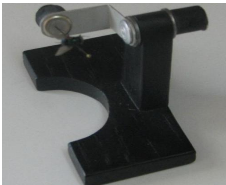
Figura 14. Dispositivo utilizado como soporte para insectos (malacanchoncha).
