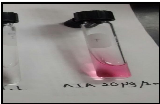
Figura 5. Reacción de AIA comercial en la aplicación del reactivo de salkowski (7.5 ml \text{HClO}_4 , 0.056 g \text{FeCl}_3 anhidro en 12.5 ml de \text{H}_2\text{O} ), en relación 1:1.
