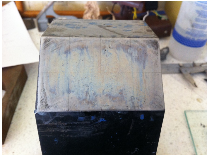
Figura A.2: líneas de posición de las galgas extensiométricas según el puente de Wheatstone
