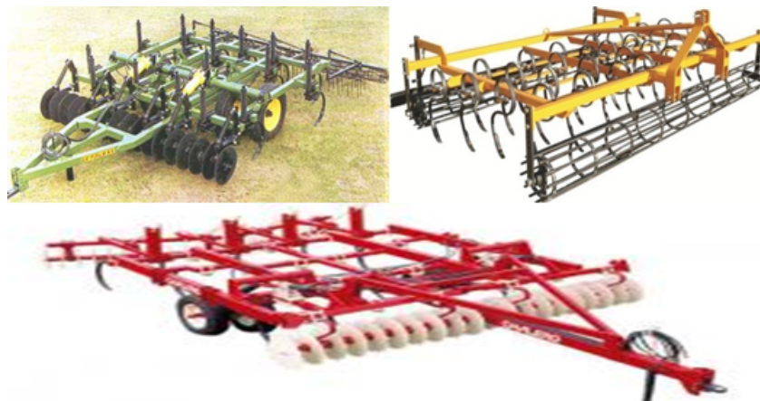
Figura 2.1: Implementos en labranza vertical a) Arado de cincel rastrojero, b) Vibro-cultivador con placa niveladora y desterronador, c) Cultivador de campo rastrojero.
