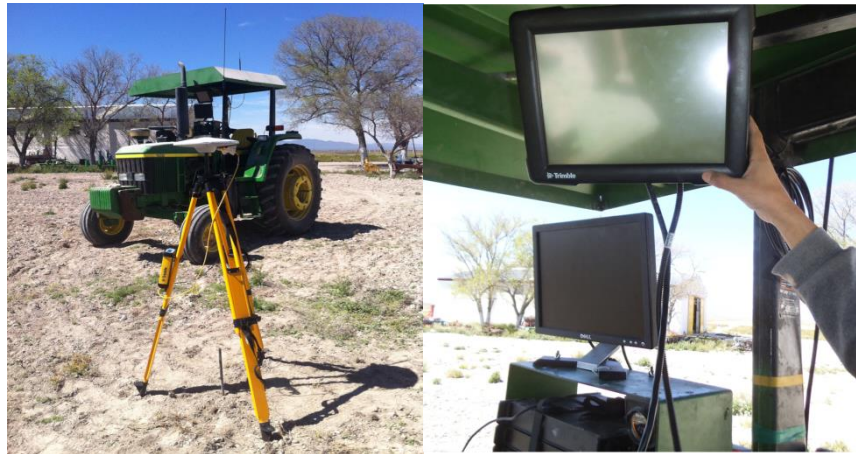
Figura 3. Tractor instrumentado (controlador FMX, GPS+ RTK, sensor de profundidad, sistemas de adquisición y procesamiento de la información). Fuente: Foto propia
