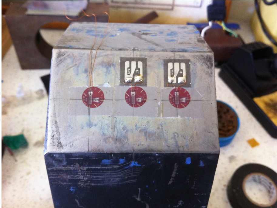
Figura A.5: Colocación de conectores galga-cable.
