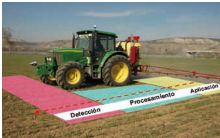
Figura 2.23: Sistema de tratamiento en tiempo real con sensor de vegetación situado al frente del tractor (cortesía de www.umwelt.fritzmeir.de ).
