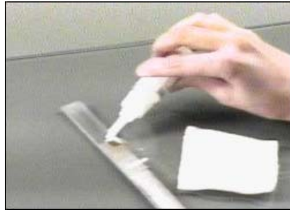
Figura 3.9 Aplicación de adhesivo M-bond 200.
