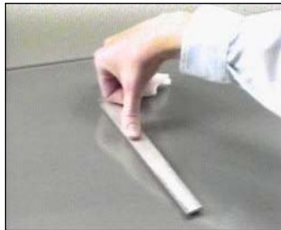
Figura 3.10 Pegado de galga extensométrica.
