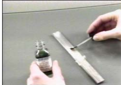
Figura 3.8 Aplicación de catalizador.
