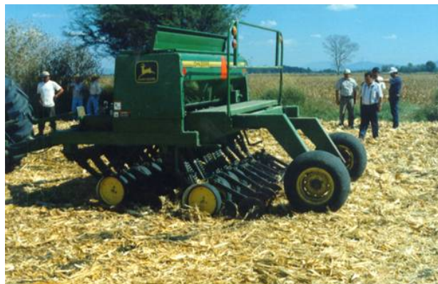
Figura 5. Sembradora múltiple para siembra directa de cebada y trigo.
