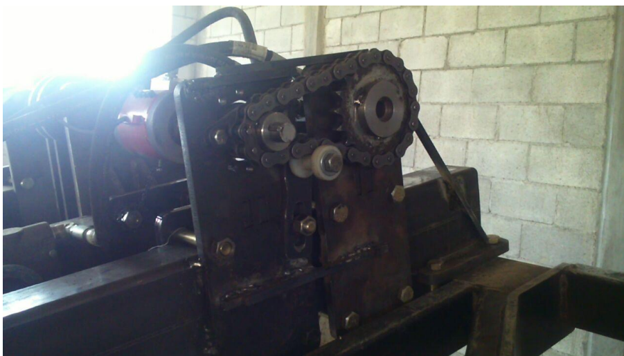
Figura 4.8. Relación de transmisión del motor hidráulico al eje del sistema vibratorio en una proporción de 19:9
