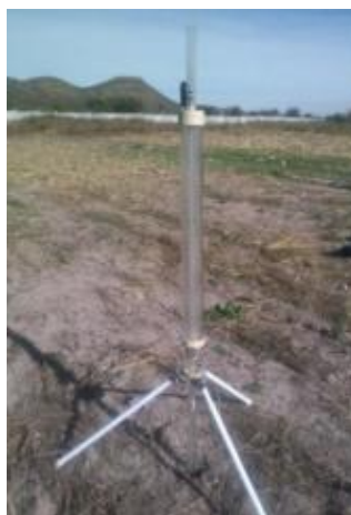
Figura 15. Permeámetro armado y ensamblado
