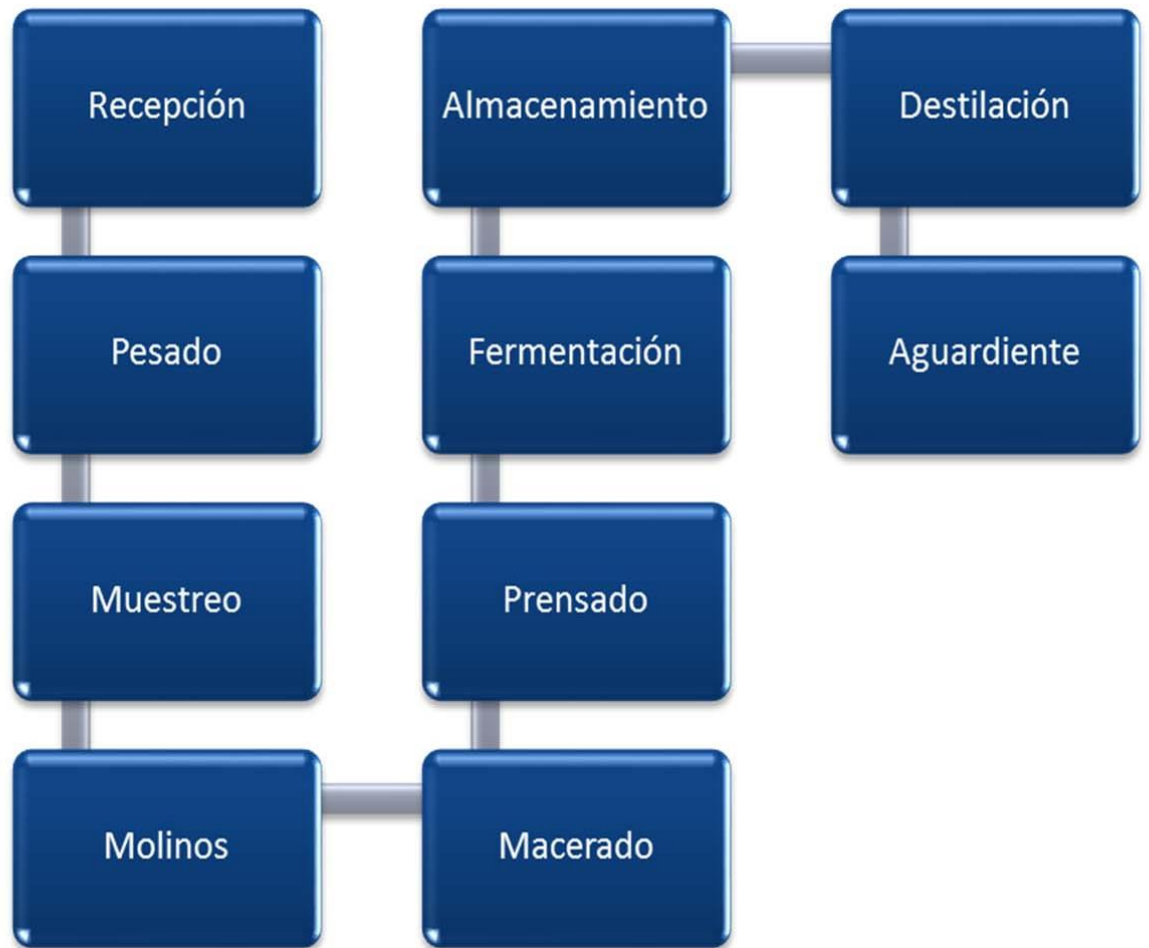
Figura 1.- Diagrama del proceso para la obtención del agua ardiente.
