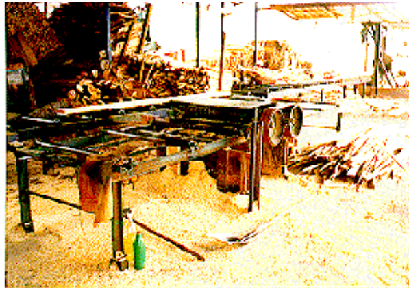
Figura 5. Sierra desorilladora o canteadora.
