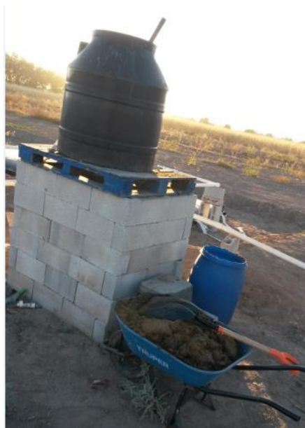
Figura 7. Sistema de colecta de estiércol de ganado bovino de la UAAAN-URL para el mezclado con los residuos alimentarios.
