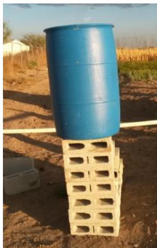
Figura 6. Sistema de recepción de residuos alimentarios para la alimentación de digestores.
