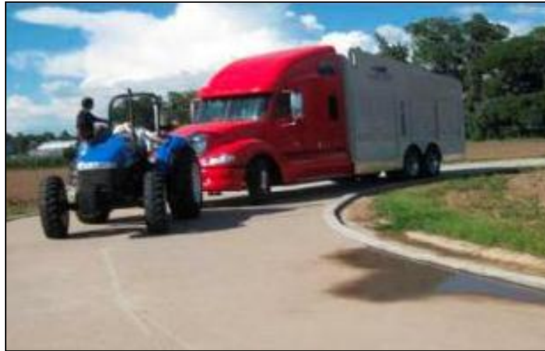
Figura 4.3 Prueba de barra de tiro
