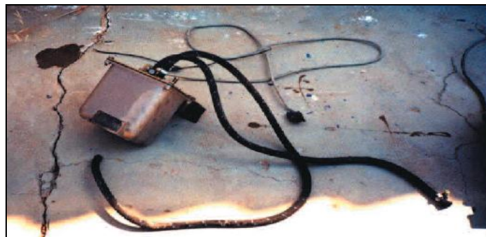
Figura 4.9 Medidores de combustible de pulsos
