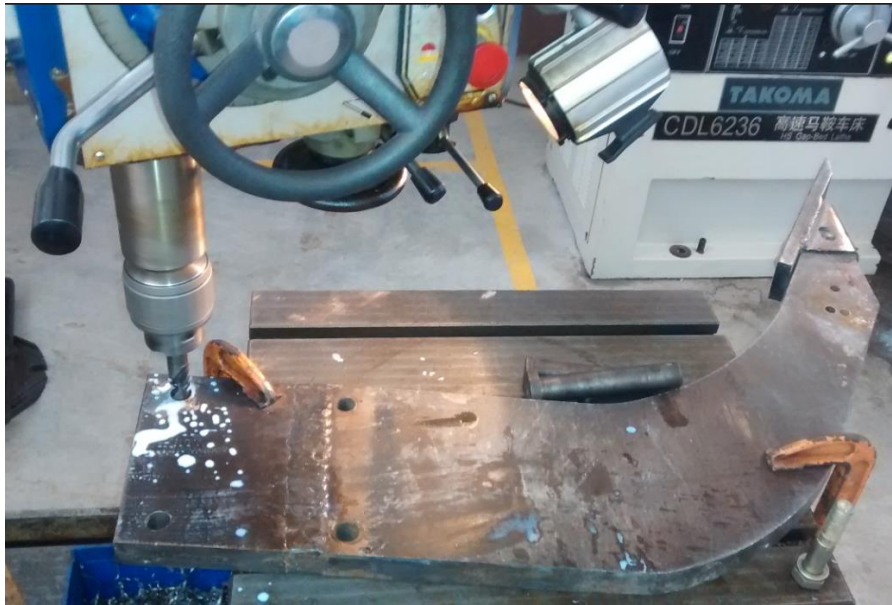
Figura 3. 3. Acondicionamiento de cincel trasero.
