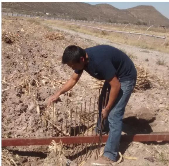
Figura 4. 10. Toma de lectura de los perfiles del área disturbada.
