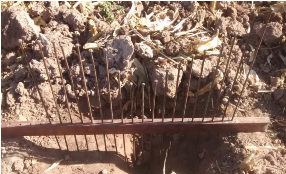
Figura 4. 16. Toma de lectura del perfil con el suelo removido.
