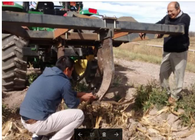
Figura 3. 9. Cambio de alas del cinzel trasero.
